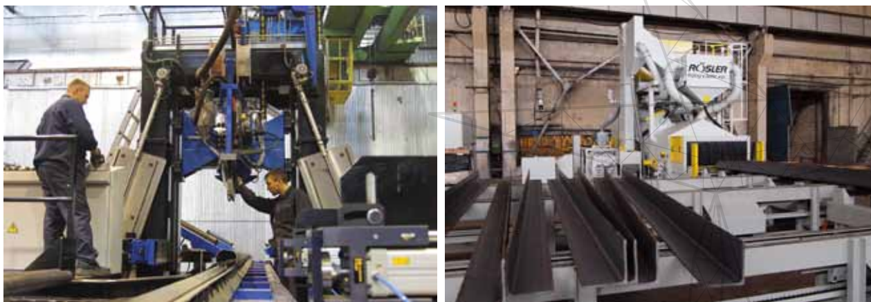
Автоматическая машина для сварки многогранных опор.
